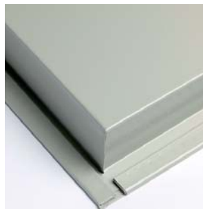
Hoja: Dos chapas de acero galvanizado unidas entre sí, con doble plegado y cosido. Aislamiento de lana de roca de 51 mm de espesor y alta densidad.
