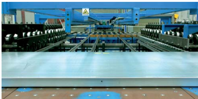
Línea automática de perfilado y ensamblado de puertas Automatic profiling and door assembly line Ligne automatique de perforation et d'assemblage de portes
